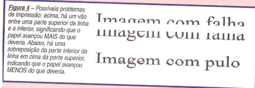
Imagem com pulos ou remontes na horizontal: falhas no sentido paralelo indica que a página avançou indevidamente em algum ponto da impressão, é provável que antes do cilindro fotossensível. Sobreposição da imagem sugere que ao invés de avançar a página parou indevidamente algum ponto antes de atingir o drum.
